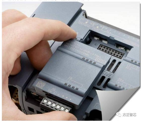
CM是英文Communication Module的缩写,中文翻译为"通信模块"; CB是英文Communication Board的缩写,中文翻译为"通信板"。通信模块是安装在轨道上的,通信板是插在CPU的板槽里的,外形上就不一样。前面我们讲过CM1241通信模块有3种,支持RS232\422\485电气接口; 而通信板只有一种: CB1241-RS485,仅支持RS485电气接口,订货号: 6ES7 241-1CH30-1XB0。
