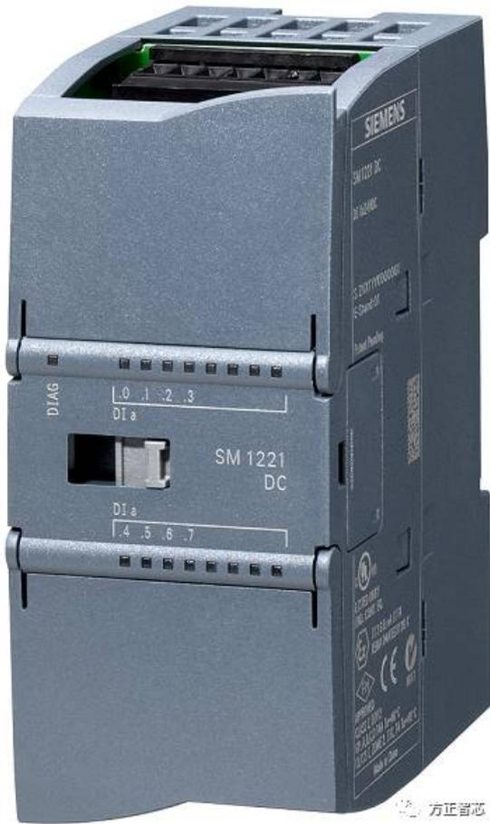
该模块消耗背板总线电流为105mA；8个数字量输入通道，每使用一个，消耗的电流为4mA（24V传感器电流）；另一种16通道输入的模块SM1221 16DI x24V如下图：
