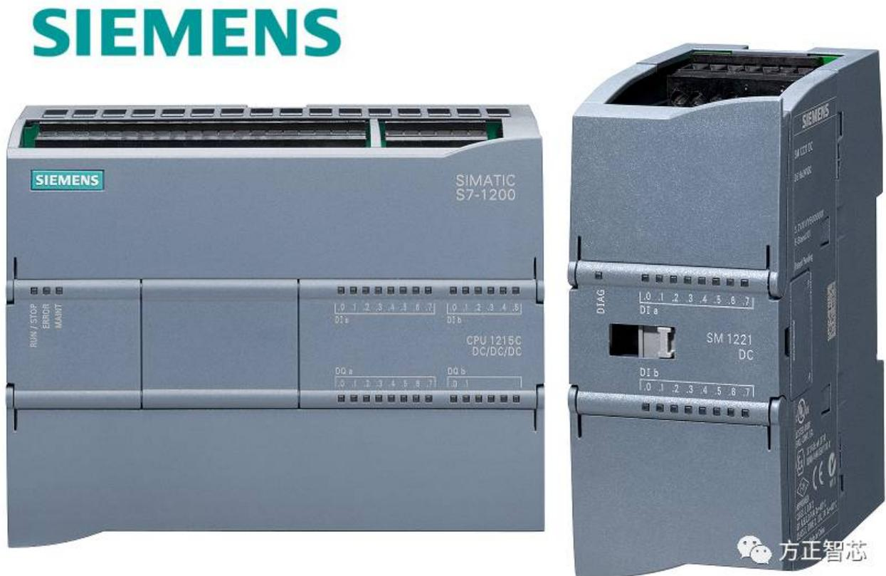
SM1221 8 DI x24VDC有8个输入通道，订货号：6ES7-221-1BF32-0XB0，如下图：
