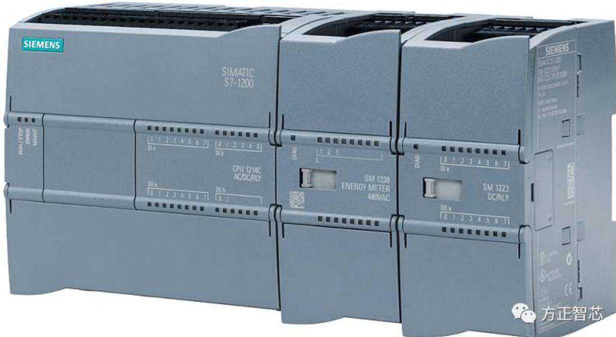
SM1223的输入部分包括8通道输入和16通道输入两种，输出部分包括8通道继电器、8通道晶体管、16通道继电器和16通道晶体管四种，如下图：
