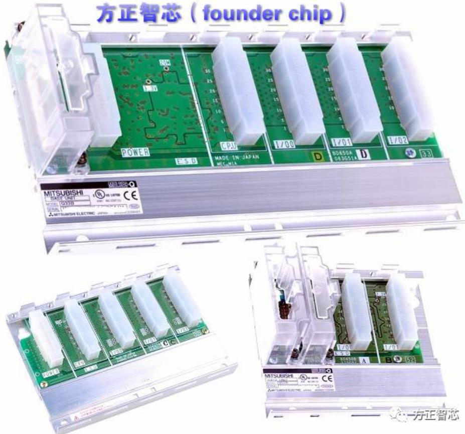
基板是用于安装电源模块、CPU模块、输入输出模块及智能模块等模块的底板，它是信号模块的载体，起到供电和信号传送的作用。
