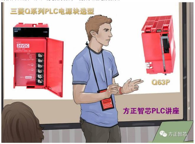
Q系列PLC的电源模块包括Q61P-A1, Q61P-A2, Q61P, Q62P, Q63P, Q64P等。名称中"Q"表示Q系列PLC; "6"代表电源,之后的数字是型号编号; "P"代表"Powere(电源)"。
