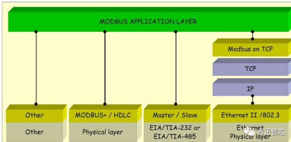
在串行链路中，我们（Modbus）使用一种简单的主从协议（客户机/服务器协议）进行通信。客户机作为主站，向服务器发送请求；服务器（从站）接到请求后，对请求进行分析并作出应答。我和小伙伴的通信帧被称为应用数据单元
