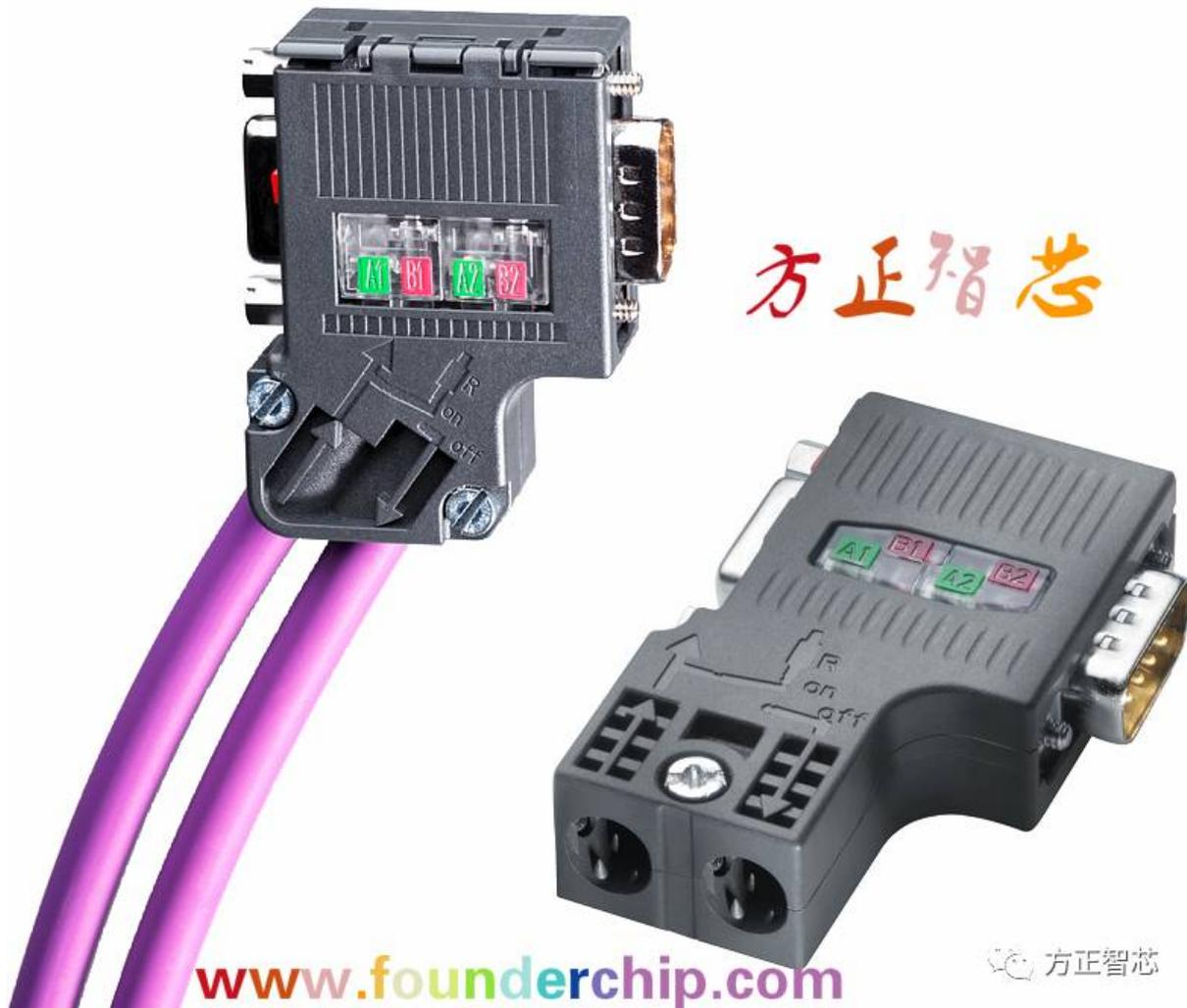
下图是Profibus总线的SUB-D9针连接器，在其左侧的红色部分，就是终端电阻的开关；连接器的下端用来连接Profibus的电缆，一进一出，每一条电缆都包含A、B两条数据线；连接器的右侧是9针插头，用来连接到CPU或者分布式模块上。
