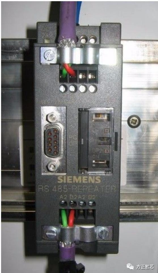
RS485中继器可以把网络分成两个网段，两者之间是完全隔离的，每一个网段的都可以达到最大通信距离。比如在1.5M bit/s的通信速率下，最大网段长度为200米。那么网段1和网段2都可以达到200米，总共可以达到400米。
