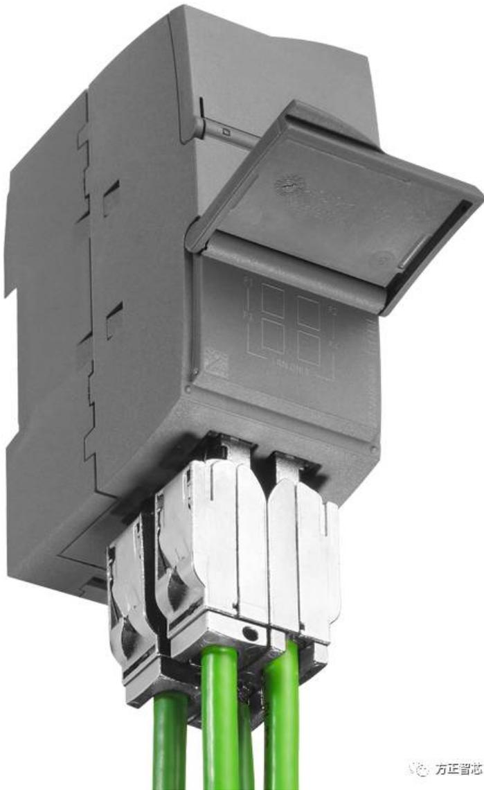
CSM1277与S7-1200系列的信号模块（SM）、通信模块（CM）不同，它没有与背板总线连接的插槽/插头，因此也不会消耗背板总线电流，不算在扩展模块的范围之内。也因为不与背板总线相连接，因此只能放在机架的两侧，不能放在中间。CSM1277属于即插即用型设备，不需要组态。
