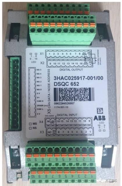
DSQC652是一款16点数字量输入和16点数字量输出的IO信号板,上图中的X1和X2是数字量输出端子,X3和X4是数字量输入端子。每个接线端子有10个接线柱,对于信号输出X1和X2而言,1~8号为输出通道,9号为0V,10号为24V+;对于信号输入X3和X4而言,1~8号为输入通道,9号为0V,10号未使用。X1~X4的接线端子的定义及分配的地址,请看下面的图片:
