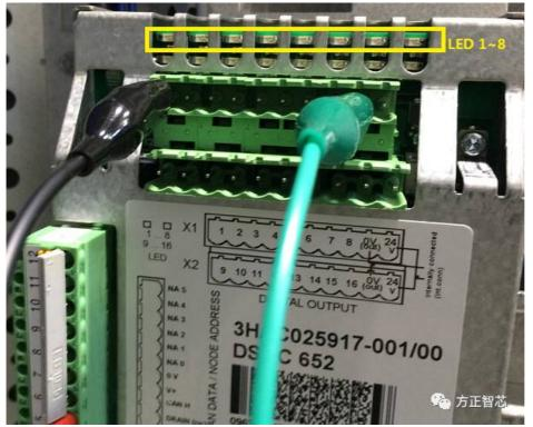
同样,在X3和X4的下方,也有两排LED指示灯,用来指示相应通道的状态,当某一通道有<mark>信号输入</mark>时,该通道的LED指示灯会点亮:
